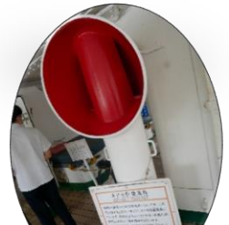
船内の換気のためのきせる型通風筒（向きを手動で変えられます）
